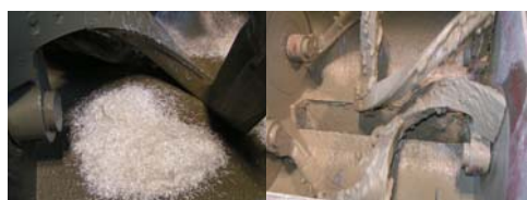
(a) 繊維投入 (b) ミキサの羽根 写真-1 練混ぜに用いたミキサ
