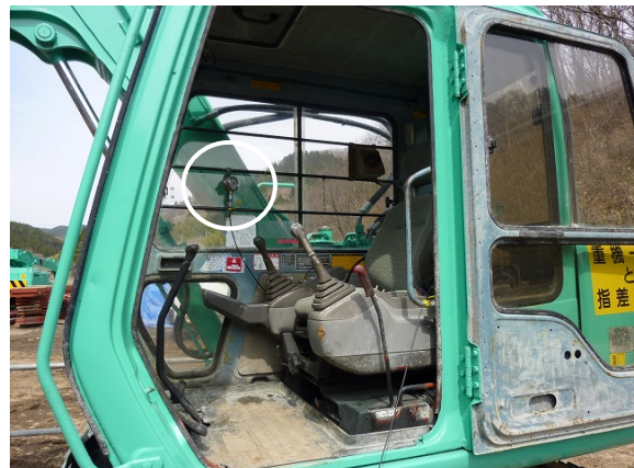
写真-1 油圧計設置状況
