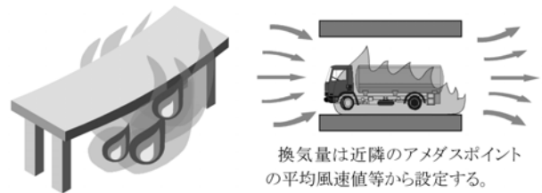
図-5 橋梁火災のモデル化
