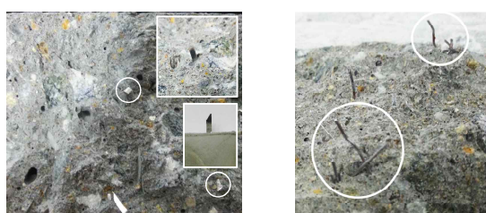
図-10 繊維の破壊性状
