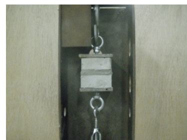
写真-2 目地の引張付着試験状況
