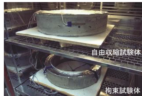
図-1 拘束リング試験の様子
