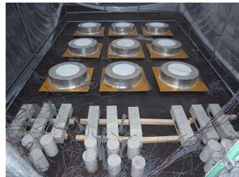
写真-3 屋外曝露試験の供試体
