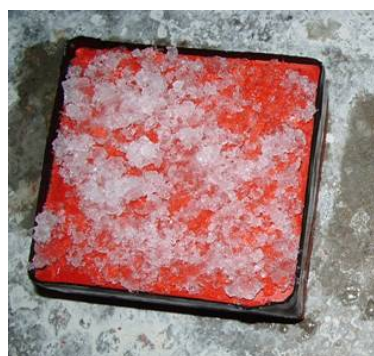
図-4 供試体上面に砕氷を積載した様子
