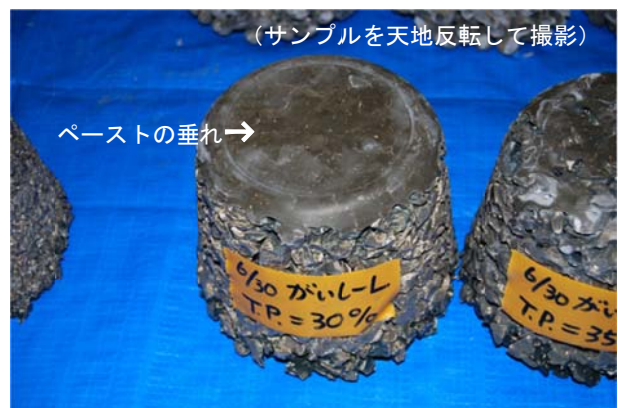
写真-1 セメントペーストの垂れ
