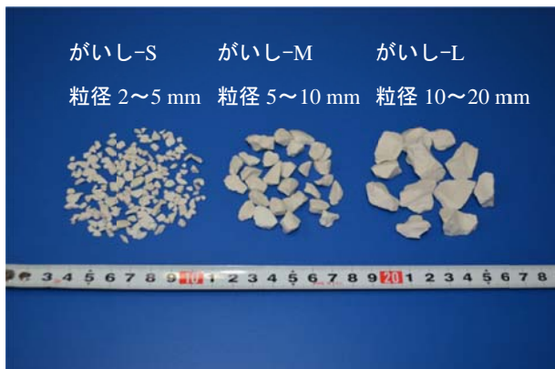
写真-2 がいし廃材破碎骨材
