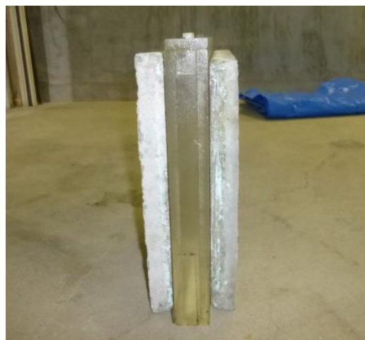
図-2 パラフィン供試体を挟む積層構造
