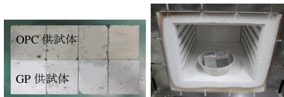
(a) 供試体切断状況 (b) 加熱装置 (材齢 7 カ月)
