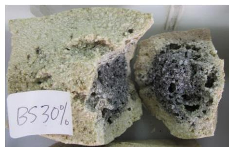
図-12 加熱に伴う供試体の膨張
