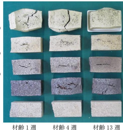
図-11 加熱後の供試体の外観
