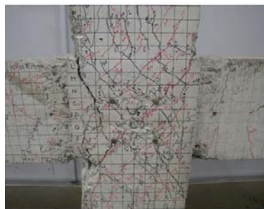
(b) 試験体 No. 2 (鋼板梁筋外側面位置)
