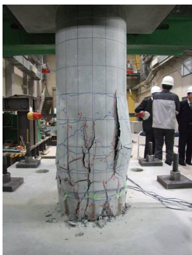
図-5 圧縮側コンクリートの圧壊・剥離 (CB-2, 部材角 0.03)
