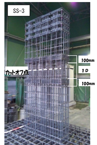
写真-2 試験体の配筋
