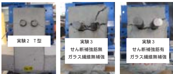
写真 - 4 最終破壊状況 No.28 写真 - 5 最終破壊状況 No.34 写真 - 6 最終破壊状況 No.38
