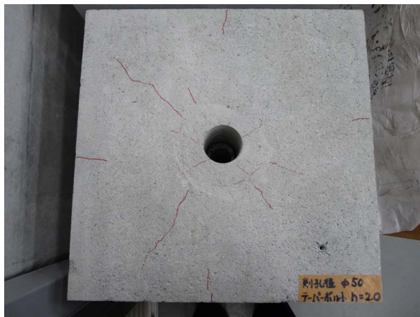
写真-5 コンクリートブロックひび割れ状況
