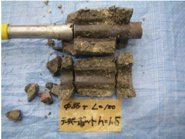
写真-3 載荷後の充填材内部 (H/D=1/1.5)
