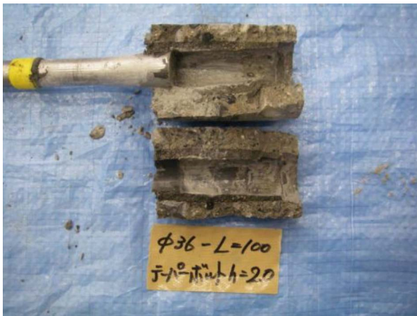
写真-4 載荷後の充填材内部 (H/D=2.0)
