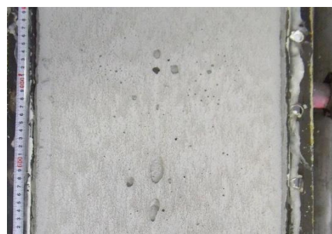
図-10 円形のエアが発生した充填モルタル
