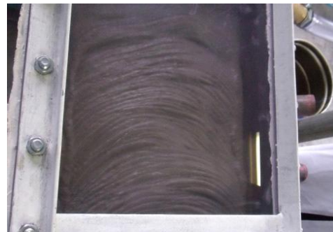
図-9 層状となった充填モルタル
