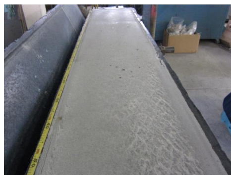
図-14 良好な充填状況
