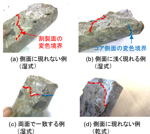
図-4 コア側面と割裂面での変色境界位置の比較
