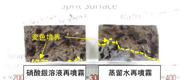
図-11 硝酸銀溶液と蒸留水を再噴霧した後の状況
