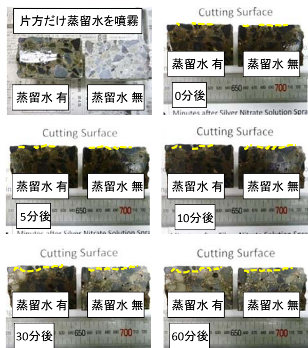
図-10 切断面における変色境界の移動の様子
