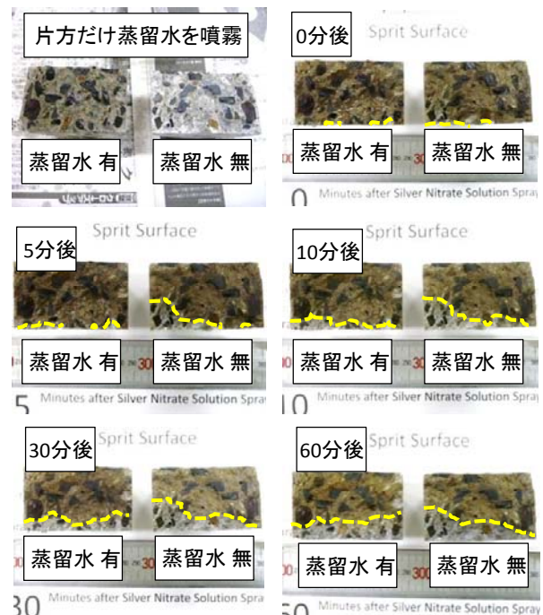
図-9 割裂面における変色境界の移動の様子
