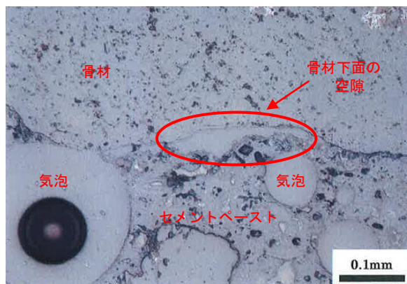
写真-2 骨材界面状態の一例 (OPC-G)
