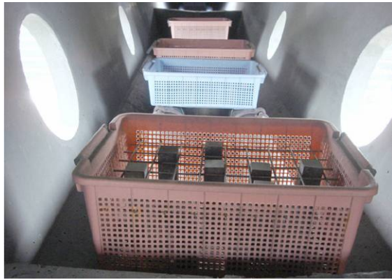
図-2 箱桁内における UFC 供試体の暴露状況
