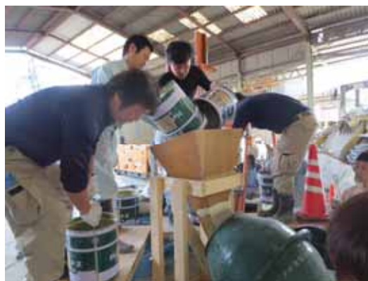
写真 - 1 試し練りミキサ用材料投入装置
