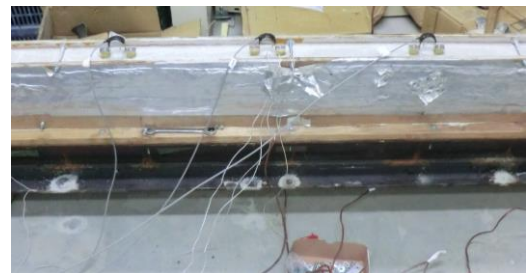
写真-2 パイ型変位計及びリボンヒーター設置状況
