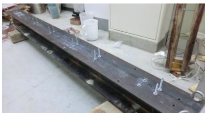
写真-1 全ねじ設置状況
