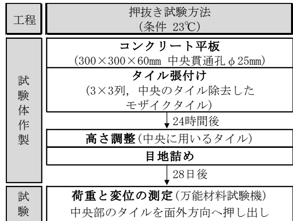
図-3 押抜き試験の流れ
