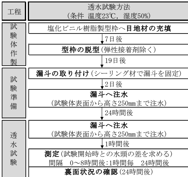
図-1 透水試験の流れ
