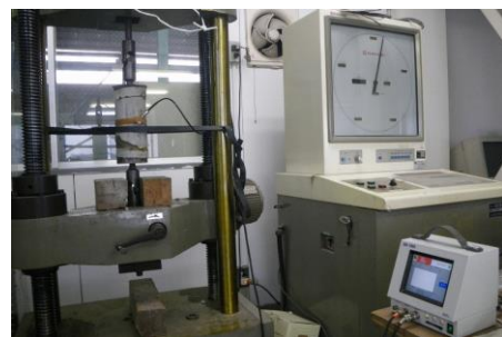
写真—2 AE 計測純引張強度試験状況
