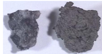
写真-1 細骨材(左)と造殻された細骨材(右)の比較
