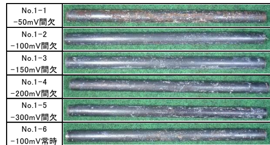
a) 貼付け型シート陽極を用いた防食供試体
