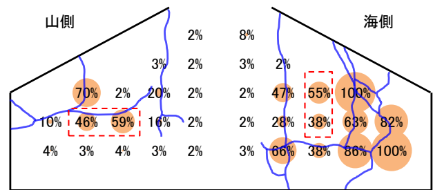
(a) 実際にはつり出した PC 鋼材の腐食率分布
