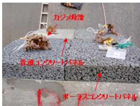
写真-3 現地試験の各種コンクリートパネルとカジメの植え込み状況
