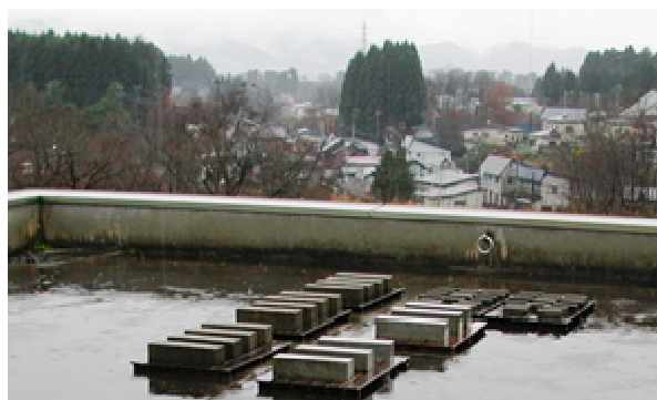
写真-1 モルタル供試体の暴露状況
