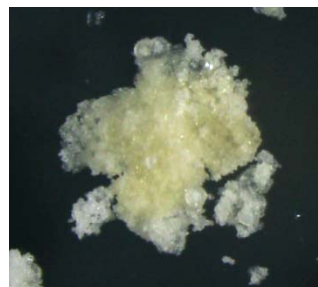
写真-1 炭酸カルシウムの結晶(倍率 150 倍)
