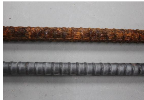
写真-2 実験使用鉄筋(上：腐食鉄筋 下：健全鉄筋)
