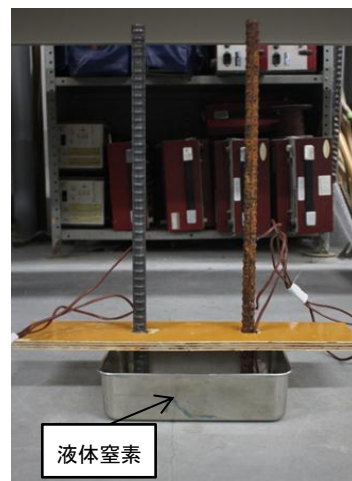
写真-3 鉄筋単体の冷却方法
