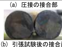
写真-1 圧接の接合部と引張試験後の接合面
