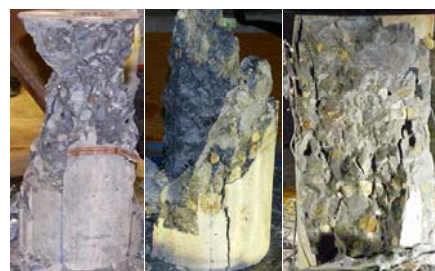
写真-5 供試体破壊状況
