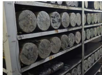
写真-3 噴霧養生室内保管状況
