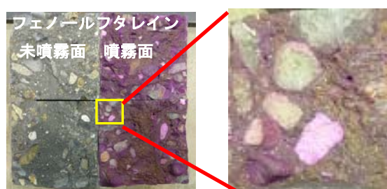
写真-7 中性化深さ試験結果（左：全体図 右：拡大図）
