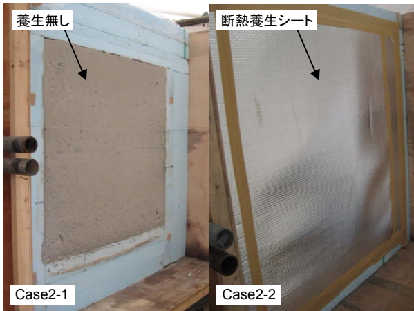
写真-1 養生シートの貼付け状況
