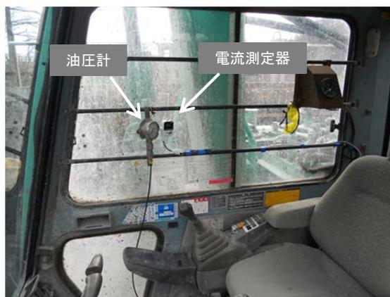
図-4 油圧計と電流測定器の設置状況
