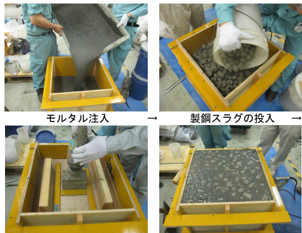
→ 簡易な締固め作業 → (3層) → 完了 写真-6 ブロック供試体の作製状況
