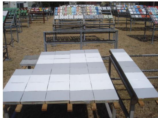
図-7 表面被覆供試体の暴露試験状況
