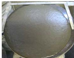
写真-2 高強度鋼繊維 写真-3 モルタルフロー
