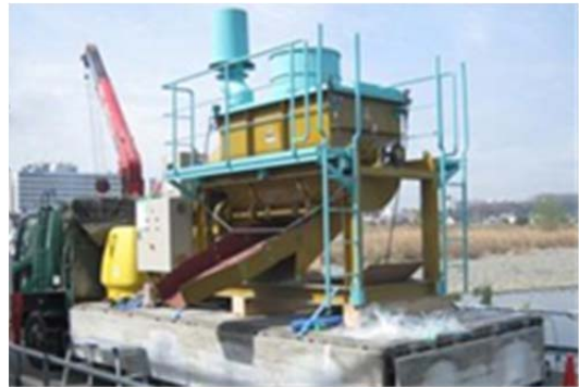
写真-4 製造に使用した車載式ミキサ
