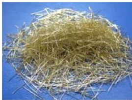
写真-2 高強度鋼繊維 写真-3 モルタルフロー
