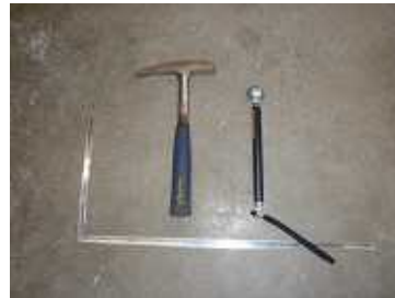
写真-2 叩き点検に用いた打撃機器(左:岩検ハンマー, 右:コンクリート点検器)
