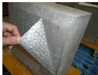
写真-1 貼付型保水・保温養生シート
