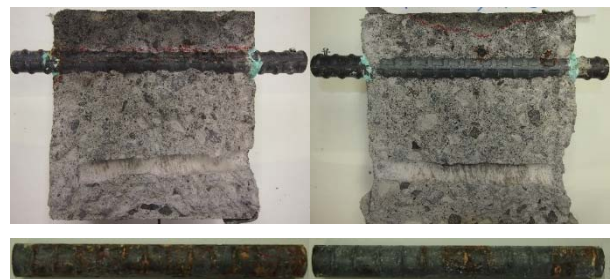
写真-2 割裂後の供試体 (左：FA65 気中、右：OPC65 気中)
