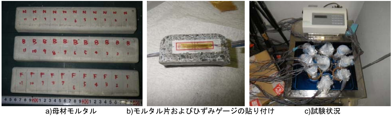
写真-1 凍結融解試験状況
