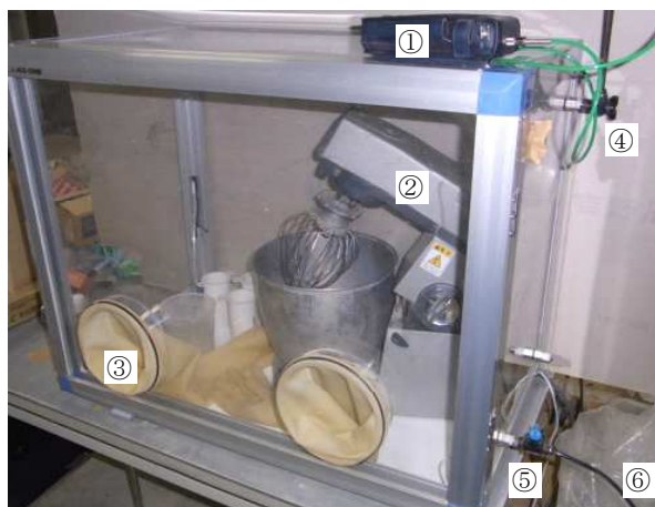
① CO 2 濃度計, ② ミキサー, ③ ゴム手袋, ④ 濃度測定口およびCO 2 出口, ⑤ CO 2 入口, ⑥ CO 2 ボンベへ接続
