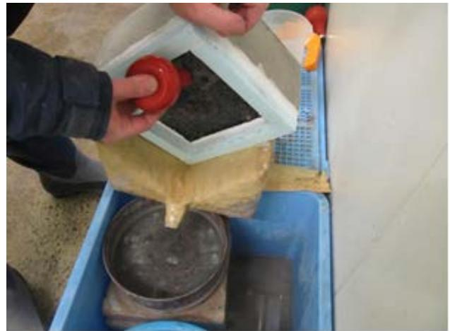
写真-4 スケーリング片の採取状況
