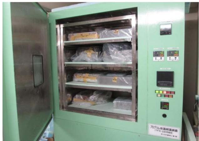
写真-2 低温恒温装置による-5℃養生の状況
