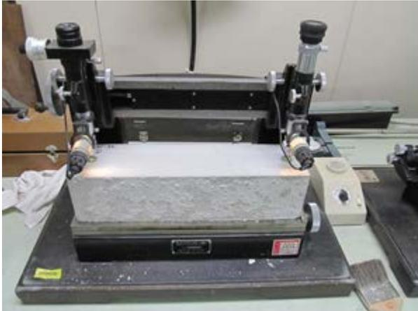
写真-3 乾燥収縮試験の状況
