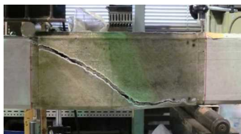
写真-3 No. 3 (等方性 FRP シート) せん断破壊状況
