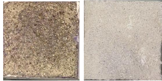
(1)接着剤使用 (2) プライマー使用
