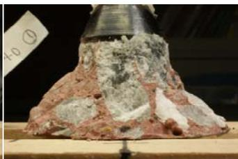
写真-1 破壊コーン形状
