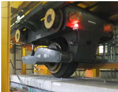
図-3 輪荷重走行試験状況
