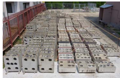
写真-3 柱部材(左), 床部材(右)の屋外暴露状況 (上面が雨掛かり面, 試験面 2 箇所測定後コア抜き)
