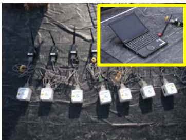
写真-2 無線加速度センサ(MEMS サーボ式)
