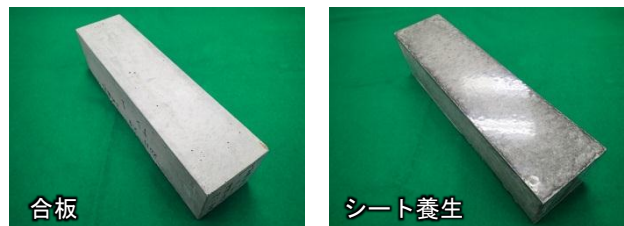
写真-2 シート養生による美観の向上(要素供試体)
